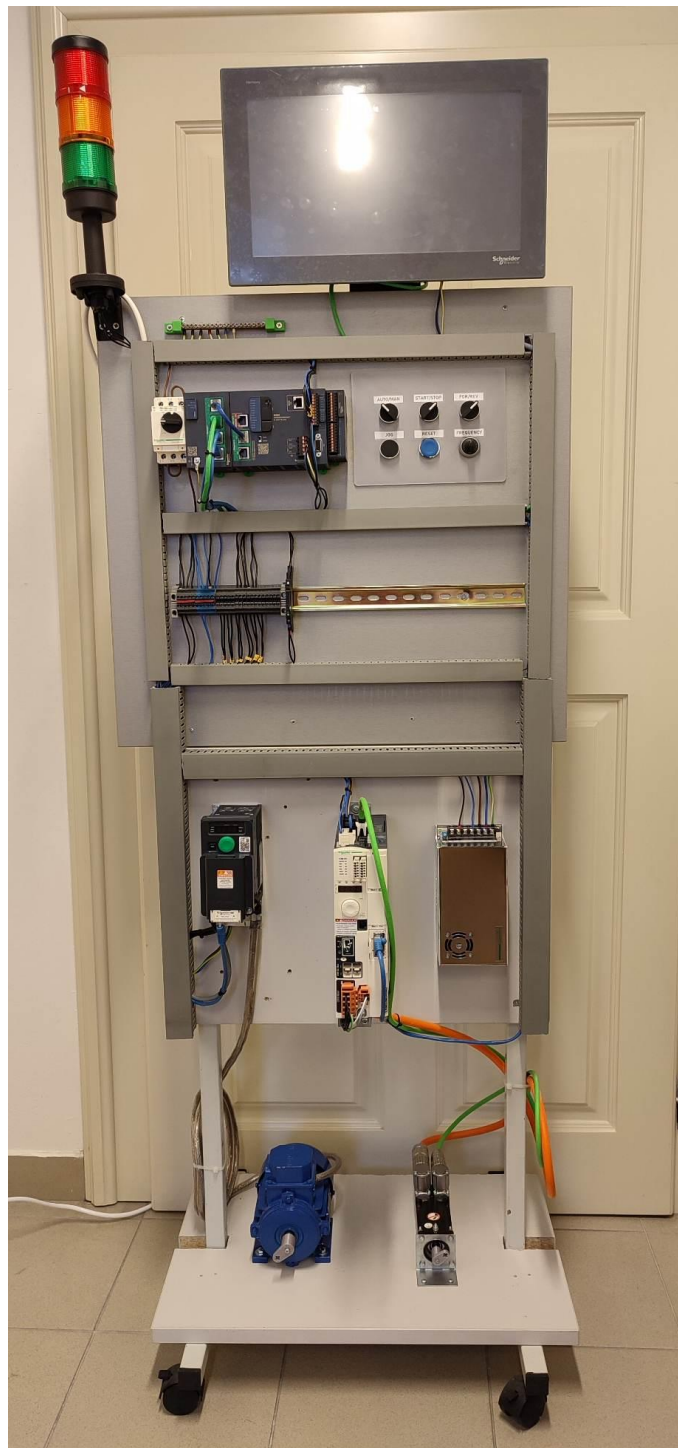
Slika 6.8: Didaktičko učilo za upravljanje asinkronim motorom i servomotorom
