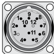
Slika 2.3: Priključak M23 za enkoder [4]
