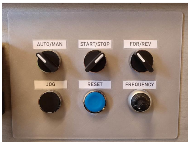
Slika 6.4: Ploča za ručno upravljanje pretvarača frekvencije ATV320
