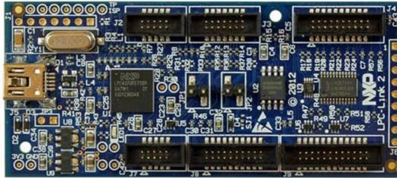
Slika 2.18: Programator tvrtke NXP [1]
