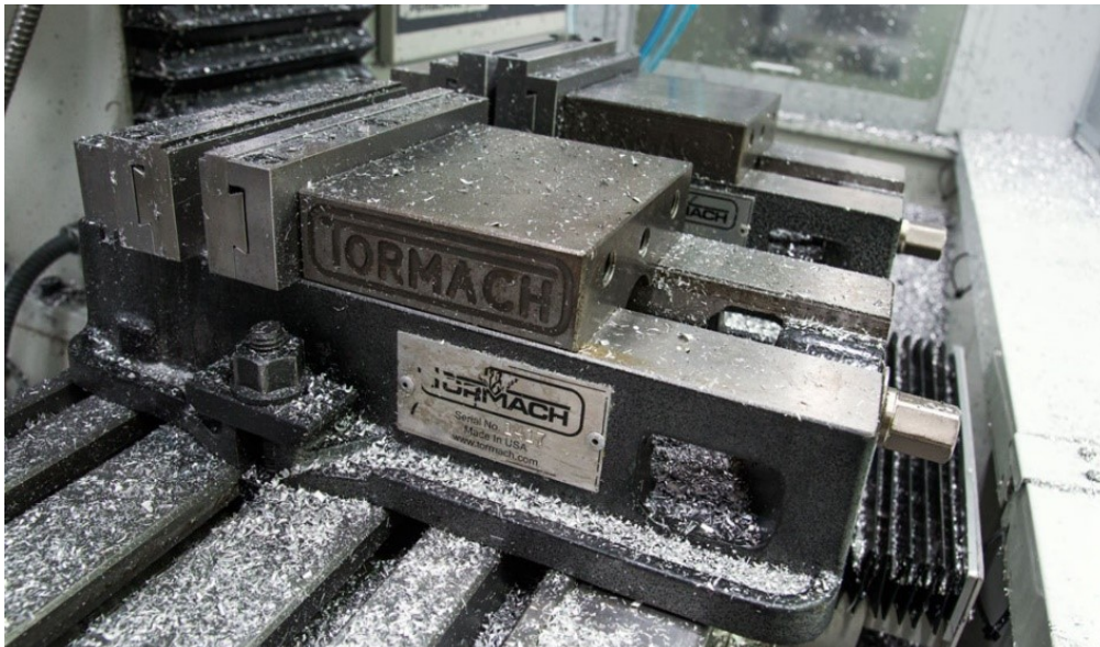
Slika 2.7 Škripac marke Tormach u CNC glodalici [6]
