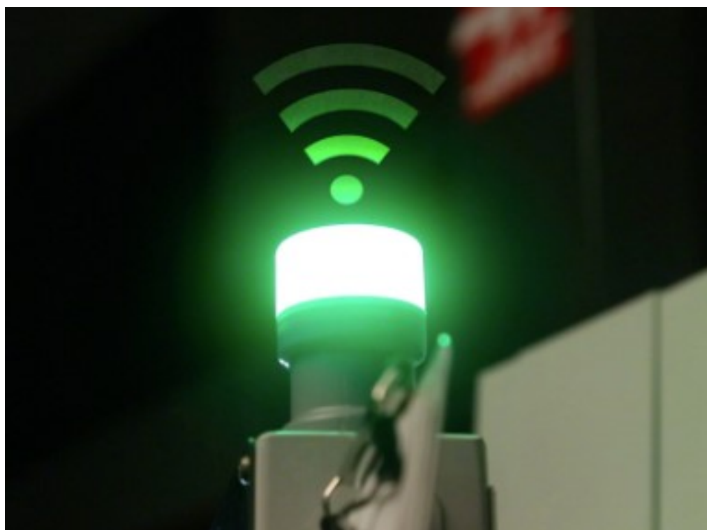
Slika 5.1 LED indikator statusa na CNC stroju marke Haas [22]
