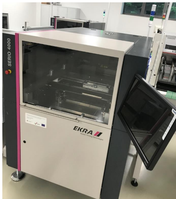
Slika 6.6: Uređaj za automatsko nanošenje lemne paste
