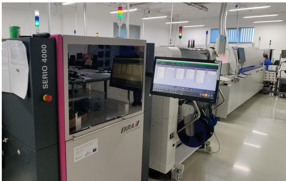
Slika 6.4: Linija za automatsko lemljenje i postavljanje komponenata
