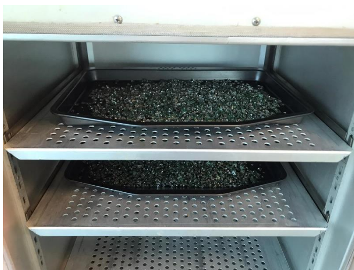
Slika 6.14: Elektroničke pločice pripremljene za sušenje
