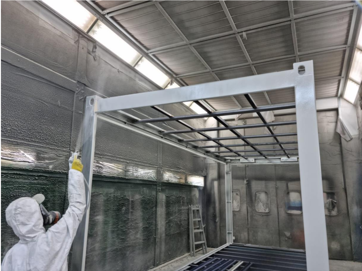
Slika 8.8 Prskanje kontejnera temeljnom bojom RAL 7035
