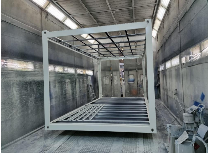
Slika 8.10 Sušenje kontejnera u lakirnici
