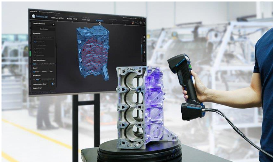
Slika 4.2.3.1 Primjer ručnog laserskog skenera [16]
