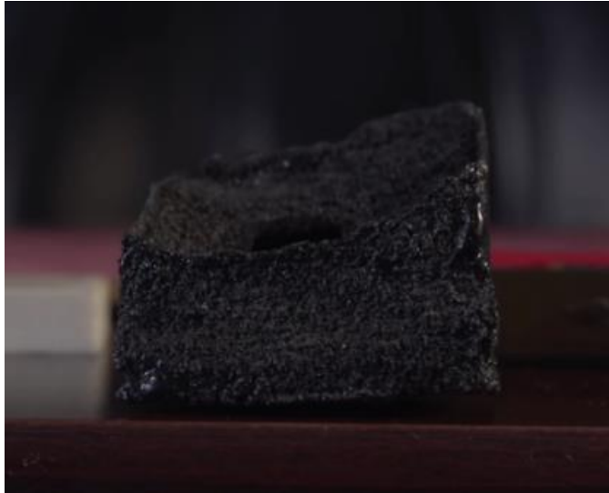
Slika 2.5 Prvi SLS 3D print
