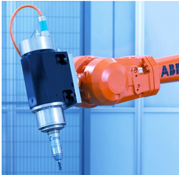
Slika 3.9. Primjer industrijskog glavnog vretena za robotsko glodanje
