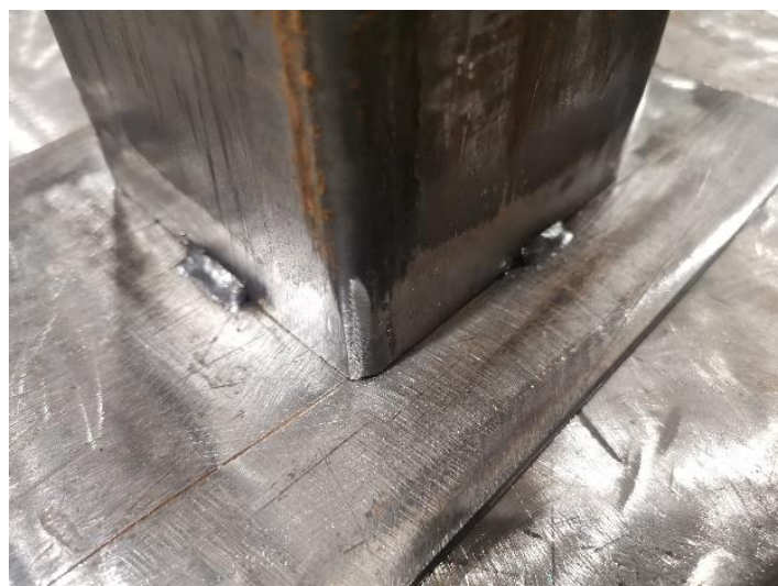
Slika 6.12: Postavljanje zavara pripajanja
