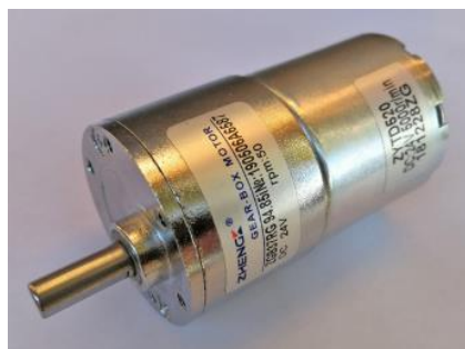
Slika 3.9: Prikaz korištenog istosmjernog motora sa reduktorom
