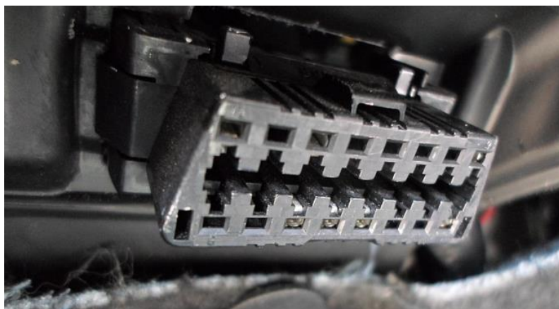
Slika 3.2: Primjer OBD priključka
