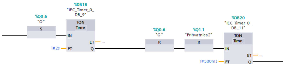
Slika 5.15 Prikaz daljnjeg procesa gdje prihvatnica zaokretnog cilindra prenosi dio do ispitnog komada
