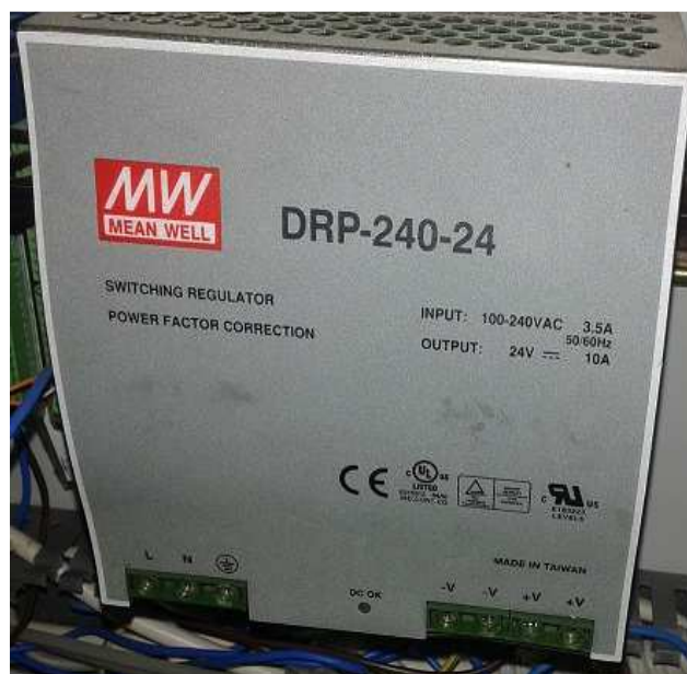
Slika 2.4: Napajanje Meanwell DRP_240_24 [5]
