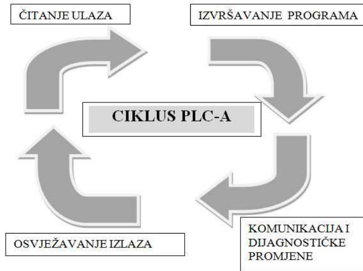
Slika 4.1: Grafički prikaz jednog ciklusa PLC-a
