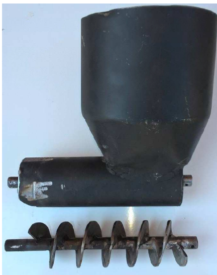
Slika 2.2: Spremnik piljevine i pužni transporter
