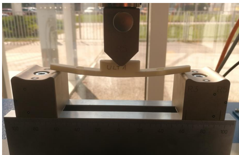
Slika 6.17: Ispitivanje na uzorku od Z-ULTRAT materijalu.
