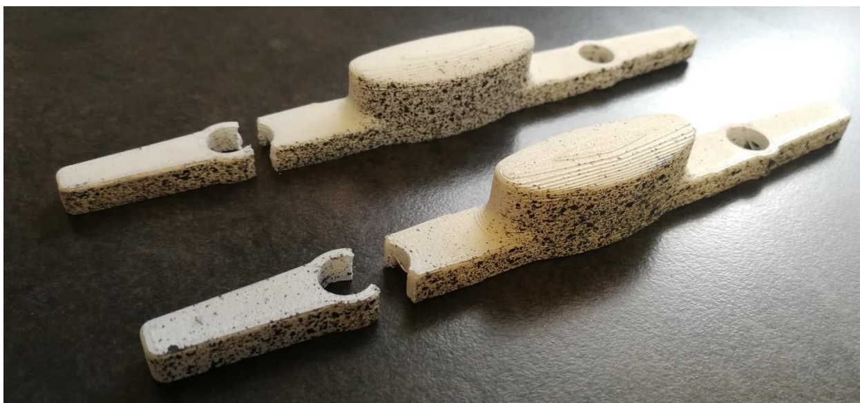
Slika 7.13: Lom na redizajniranoj kopči od Z-ULTRAT materijala.
