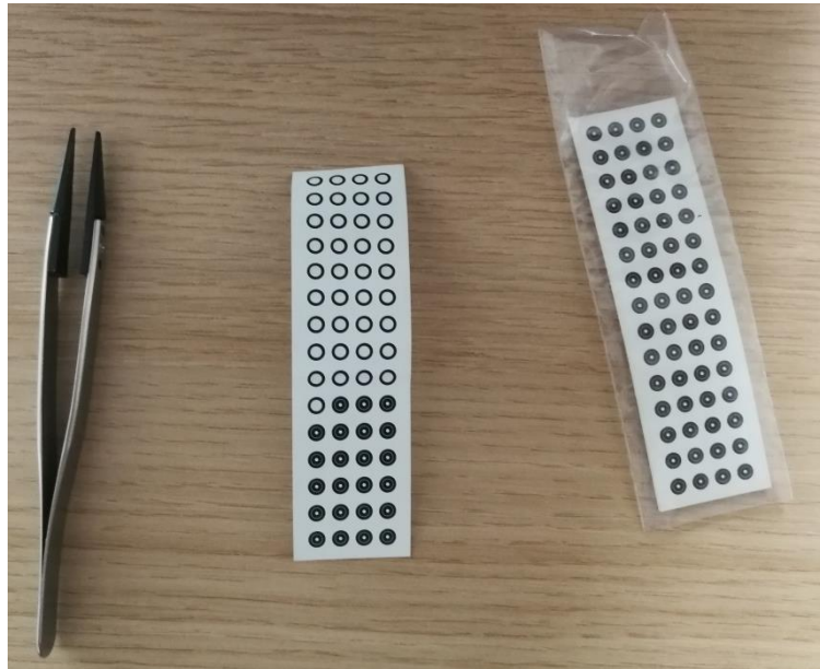
Slika 2.4: Korištena oprema i referentne točke (0,80 mm).
