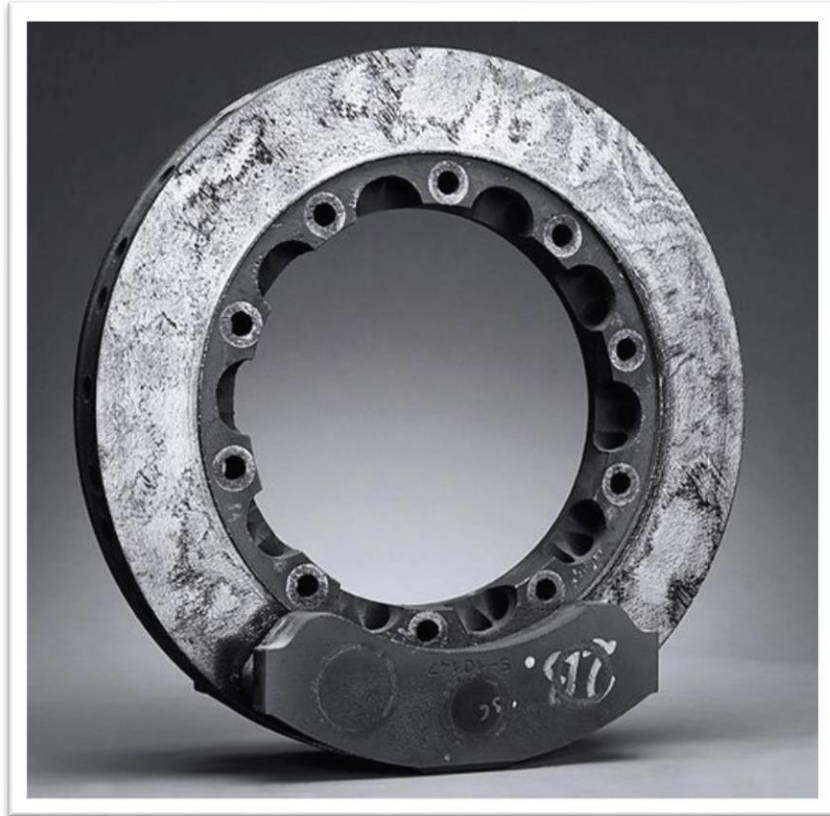
Slika 5.3: Istrošeni kočioni disk i pločica izrađen od ugljika [13]
