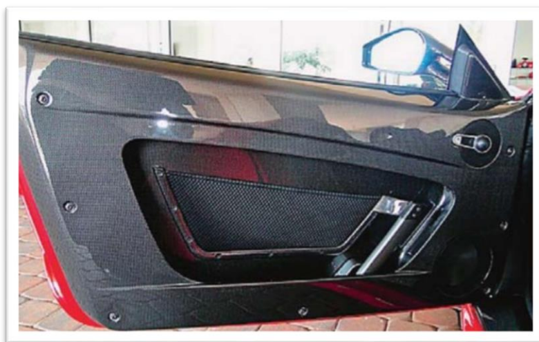
Slika 6.6: Panela vrata od plastomerne matrice ojačane ugljikovim vlaknima [18]
