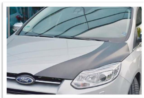
Slika 6.4: Fordov poklopac motora ojačan ugljikovim vlaknima [16]
