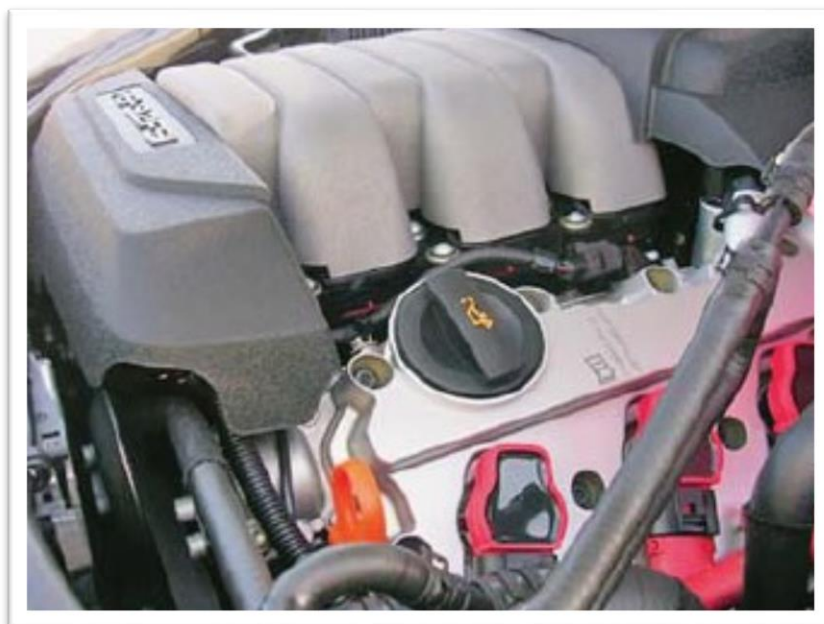
Slika 6.8: Poklopac glave motora Audi A8, 3.2 FSI [20]
