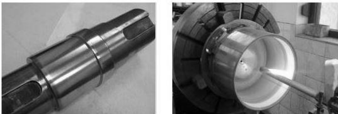
Slika 8.16: Primjeri dijelova obrađenih naštrcavanjem [74]
