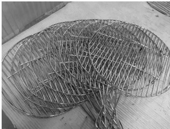
Slika 8.4: Primjer dekorativnog kromiranja (rešetka za roštilj) [64]
