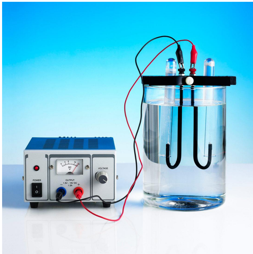
Slika 4.3: Uređaj za elektrolizu vode [20]
