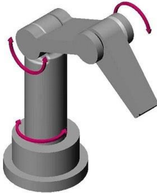
Slika 3.8. Grafički prikaz rotacijske strukture robota [34]
