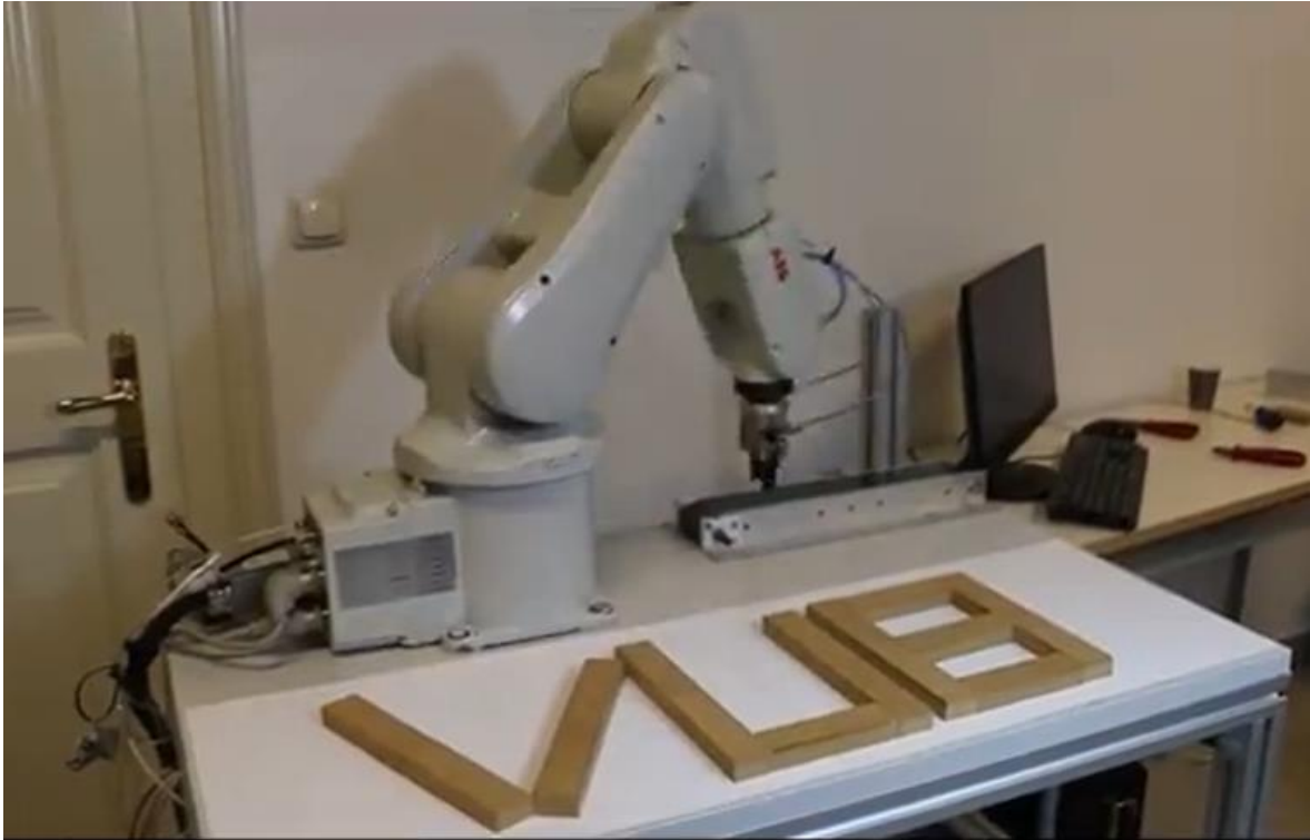
Slika 8.5. Robot ABB IRB120 izvršava program [39]
