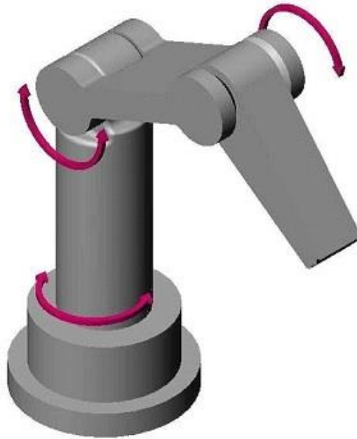
Slika 3.8. Grafički prikaz rotacijske strukture robota [34]
