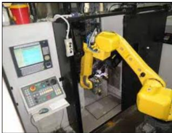
Slika 4.1. Prenosenje dijelova do stroja pomoću robota [20]
