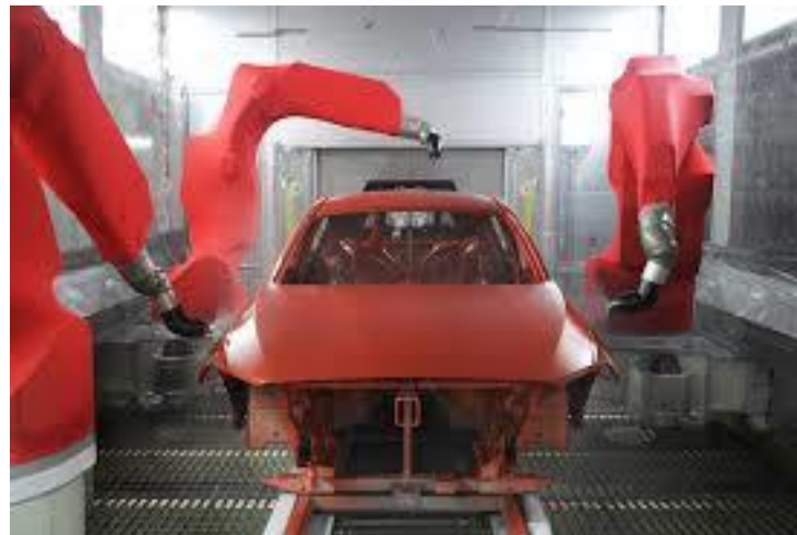
Slika 4.4. Bojanje pomoću robota [23]
