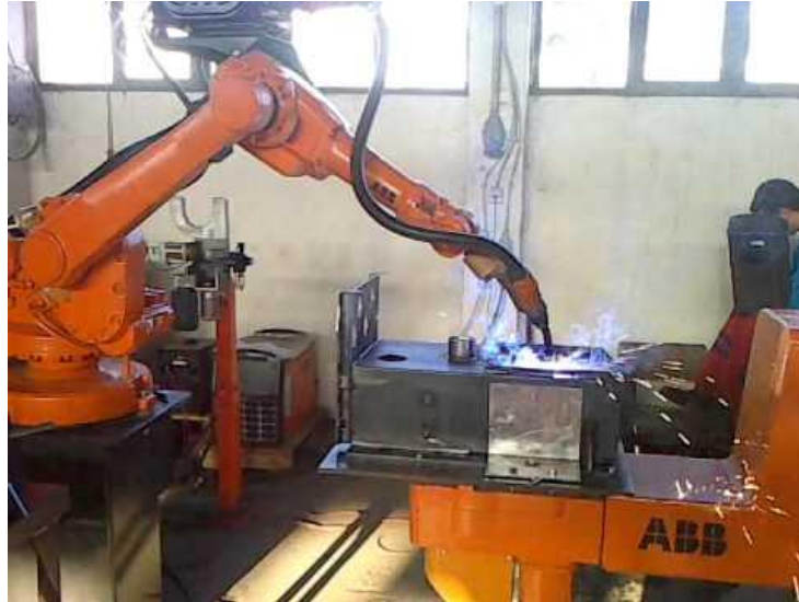
Slika 4.3. Zavarivanje pomoću robota [22]
