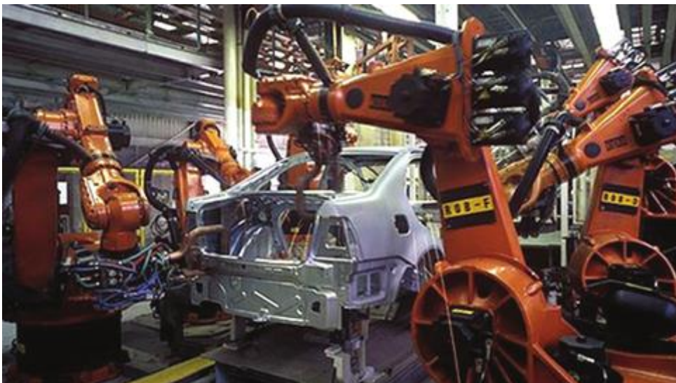
Slika 5.2. Šest osni roboti korišteni za zavarivanje u automobilskoj industriji [28]
