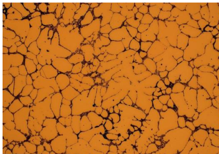
Slika 3.2: Struktura bakra (tamne čestice \text{Cu}_2\text{O} u bakrenoj matrici) [4]
