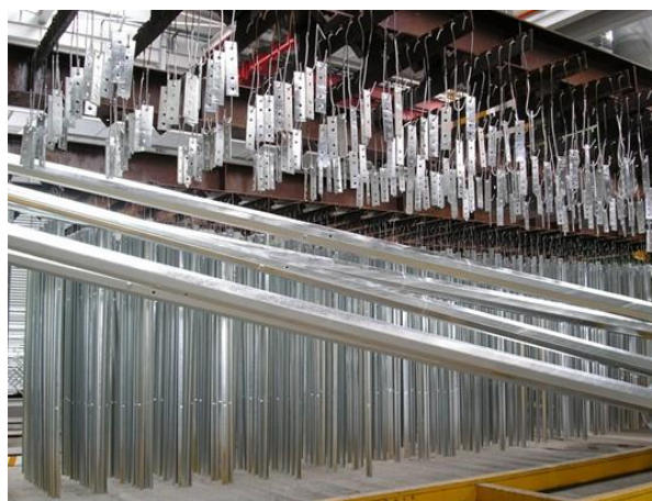
Slika 3.16: Pocinčavanje konstrukcijskih dijelova dalekovoda [17]
