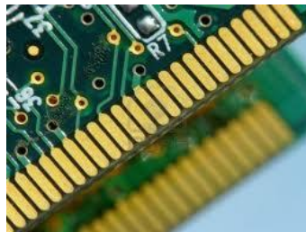
Slika 3.34: Zlato kao kontakt na tiskanoj pločici [30]
