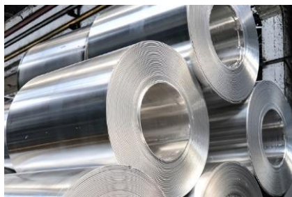
Slika 3.27: Kolutovi aluminijskog lima [26]
