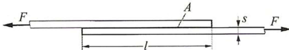
Slika 3.24: Lijepljeni prijklopni spoj limova ( s je debljina lima, l duljina prijklopa, A površina prijklopa) [10]
