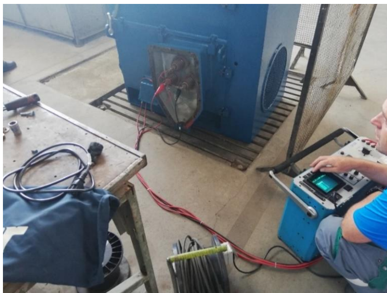
Slika 5.41: Ispitivanje namota elektromotora uređajem Baker D12R
