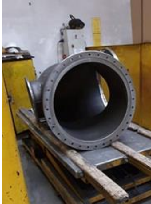
Slika 6.8: Izgled kućišta nakon brušenja i fine obrade
