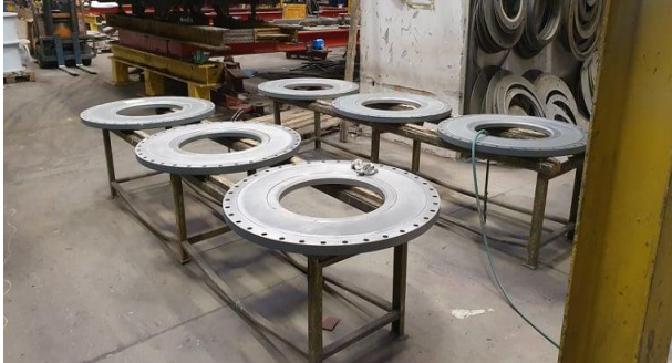
Slika 6.12: Sušenje prirubnica nakon bojanja
