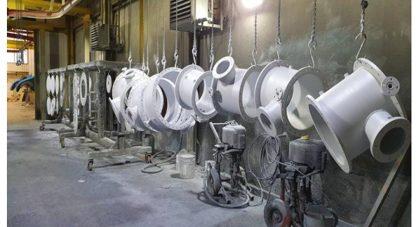
Slika 6.13: Sušenje kućišta nakon bojanja
