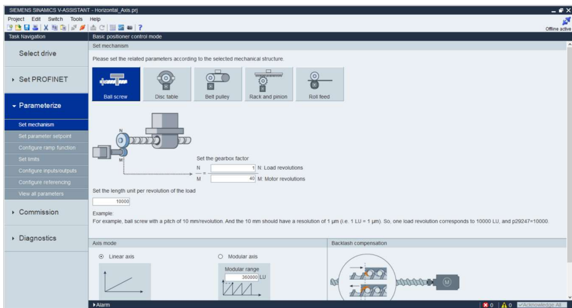
Slika 6.5 Mehanički parametri V90 servo upravljačkog sustava
