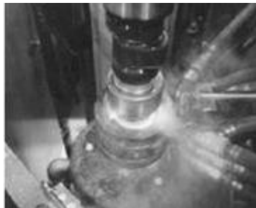
Slika 2.34 Rotacijsko indukcijsko kaljenje koljenaste osovine [14]
