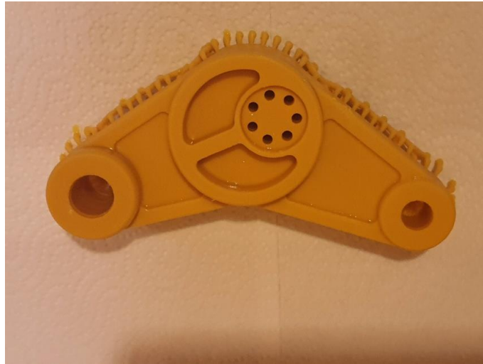
Slika 3.3. Model u zelenom stanju
