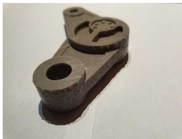
Slika 6.24. Suportna struktura SLA tehnologije
