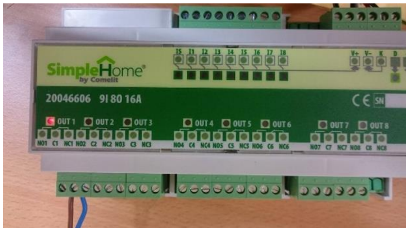
Slika 3.30. LED traka spojena na ulaz 1 na pametnom releju
