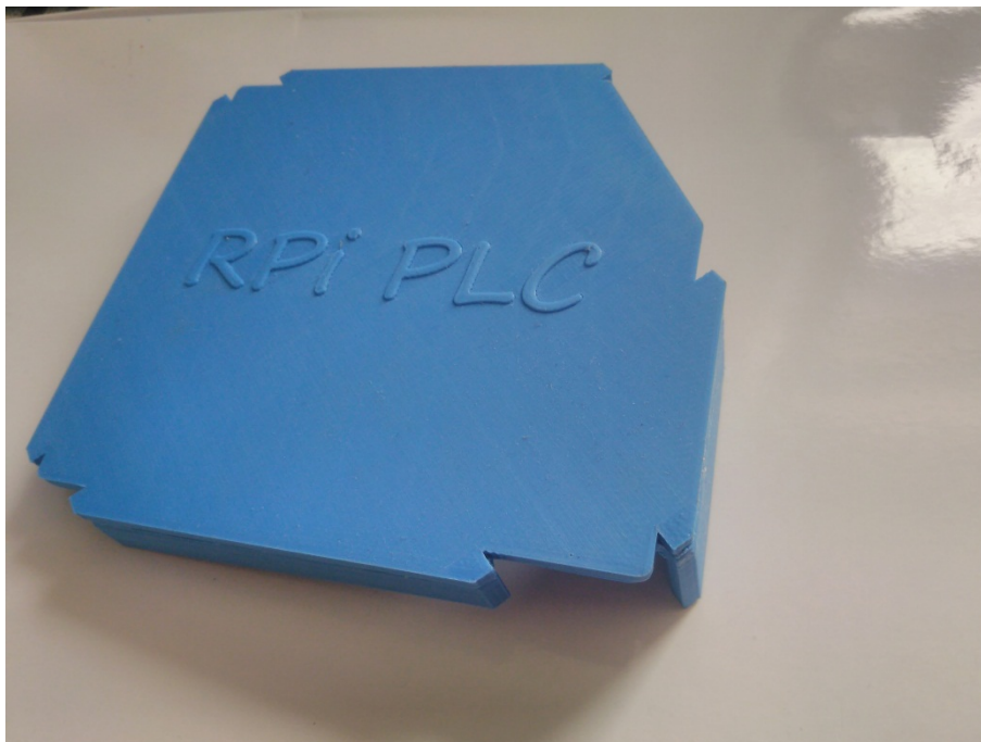
Slika 6.8 Pokrov kućišta izrađen u programskom alatu Solidworks
