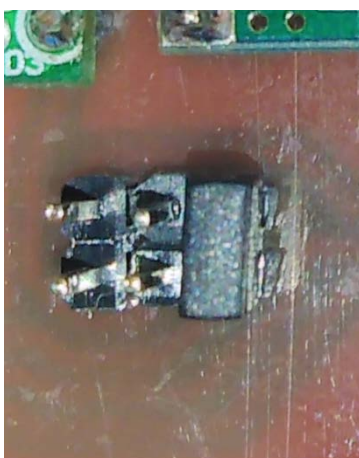
Slika 5.12 Položaj kratkospojnika za napon 6 – 30 VDC
