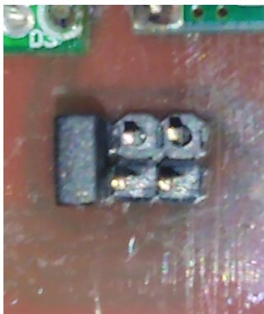
Slika 5.10 Položaj kratkospojnika za napon 5 VDC
