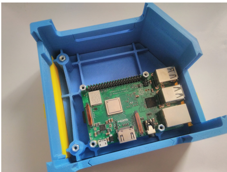
Slika 6.9 Glavno kućište sa umetcima izrađeno 3D printanjem
