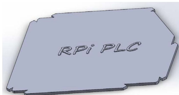
Slika 6.7 Pokrov kućišta izrađen u programskom alatu Solidworks
