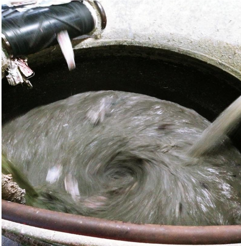
Slika 8.1: Prikaz rada palpera (palper pun mješavine i traka koja dovodi materijal u palper)
