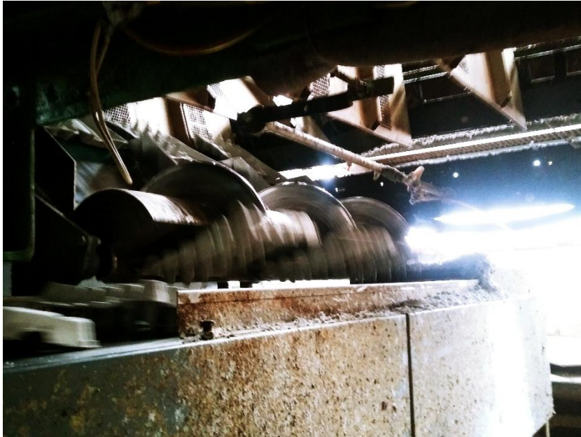
Slika 8.13: Kosina i mehanizam koji omogućuju prebacivanje podložaka na transportnu traku
