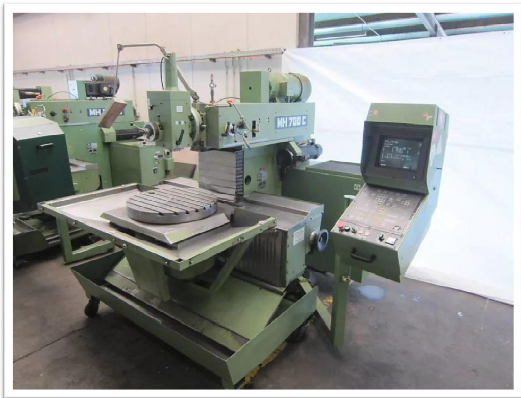
Slika 3.11. MAHO 700 C prije modernizacije [3]
