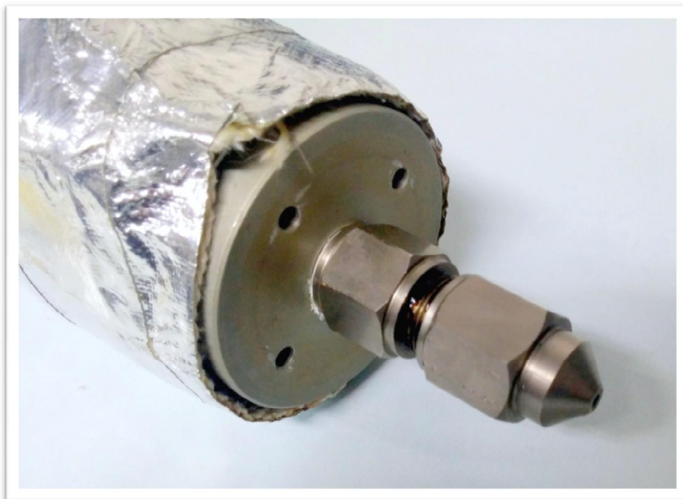
Slika 2.7. Donji dio spremnika s mlaznicom
