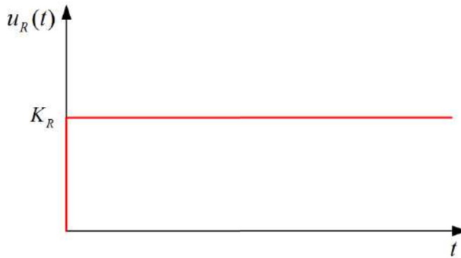
Slika 8.16: Prijelazna funkcija P regulatora
