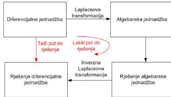
Slika 3.7: Shematski prikaz rješavanja diferencijalne jednadžbe
