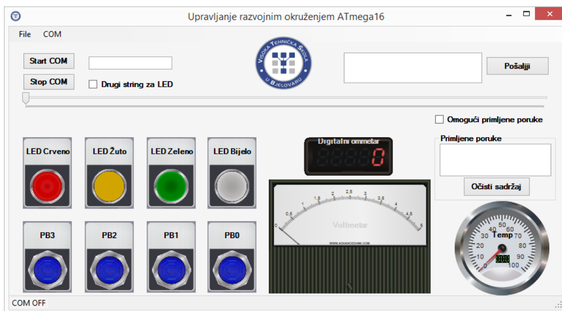
Slika 10.4: Aplikacija za upravljanje i nadzor razvojnog okruženja s mikrokontrolerom ATmega16 pomoću serijske komunikacije
