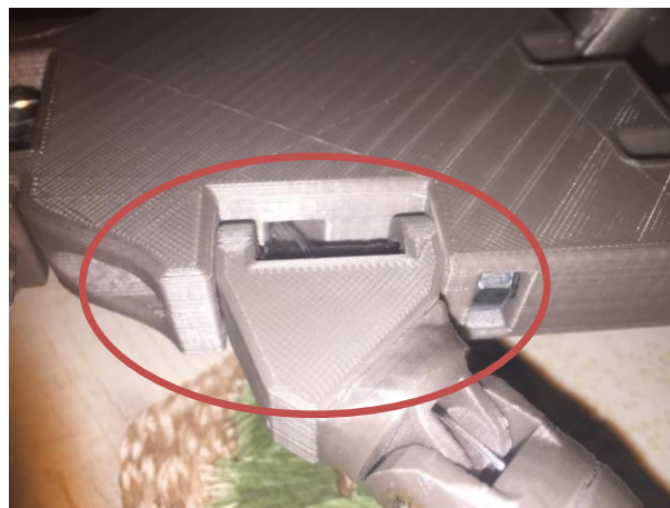
Slika 3.6: Spoj palca vijkom i maticom
