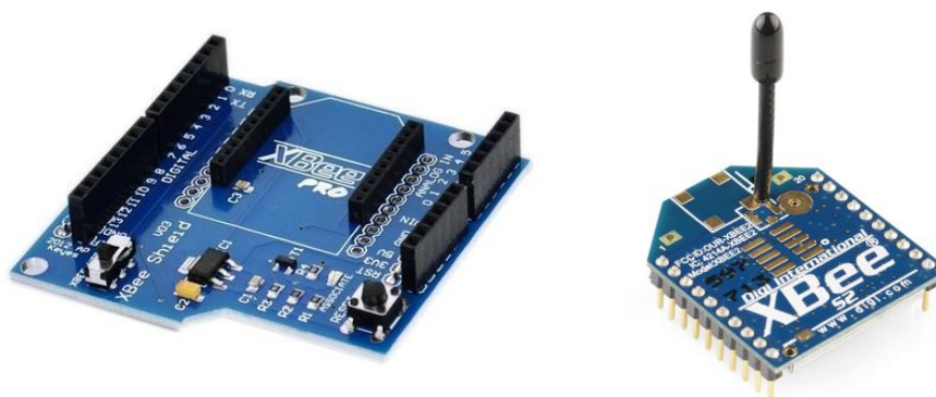
Slika 4.3: Xbee štit (lijevo) i Xbee antena (desno) [15]
