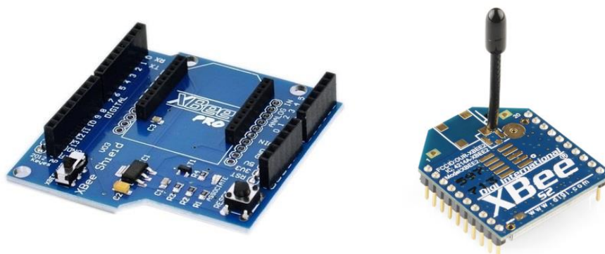
Slika 4.3: Xbee štit (lijevo) i Xbee antena (desno) [15]
