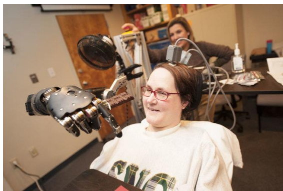
Slika 2.4: Kvadriplegična žena pomiče robotsku ruku sa svojim um [6]
