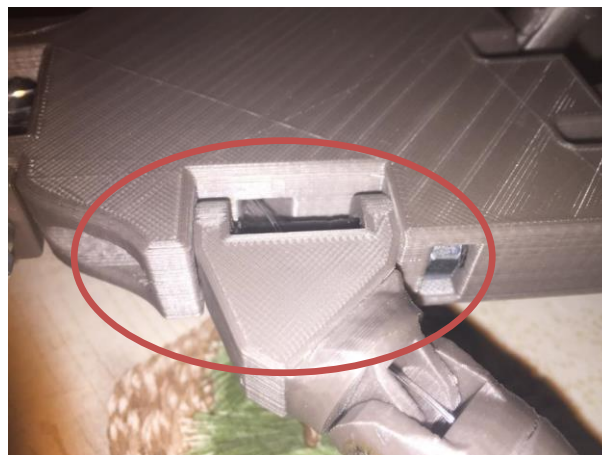
Slika 3.6: Spoj palca vijkom i maticom
