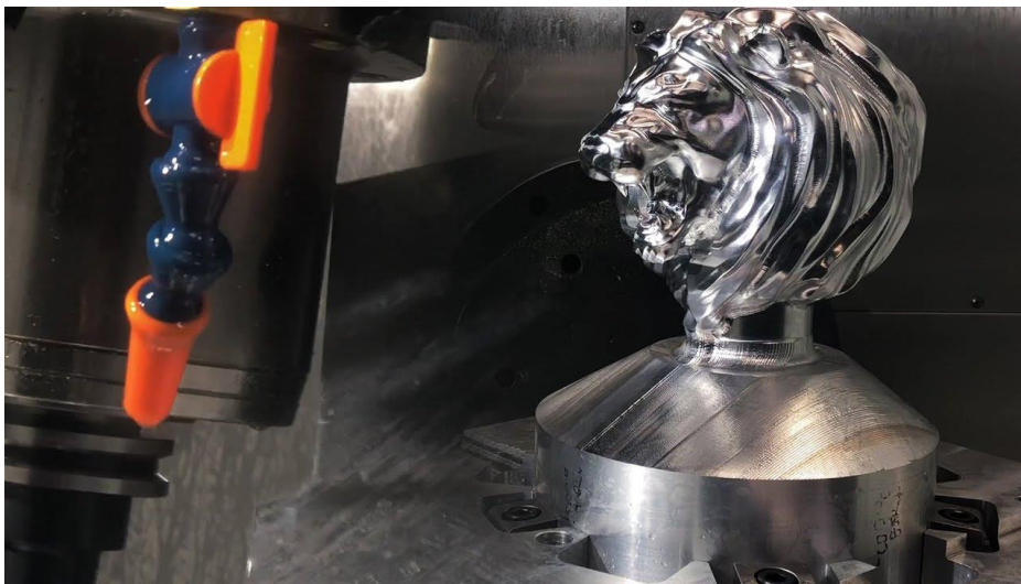
Slika 3.2. Primjer simultanog 5-osnog glodanja [19]
