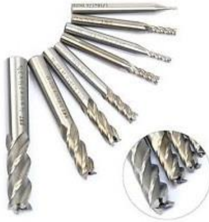
Slika 2.6. Glodala izvedena iz jednog materijala [7]
