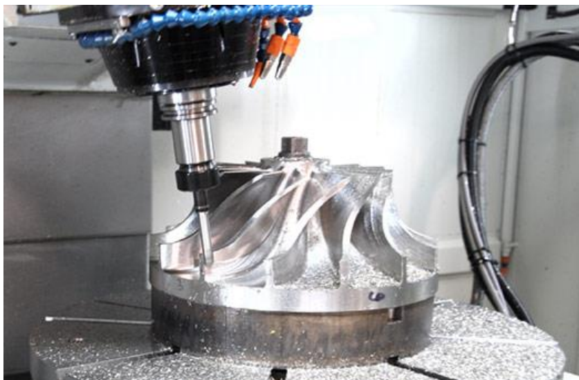
Slika 3.3. Primjer simultanog 5-osnog glodanja [20]
