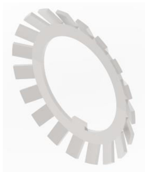
Slika 4.20 Renderirani (foto realističan) prikaz 3D modela osigurača (podloška za osiguranje navrtki)
