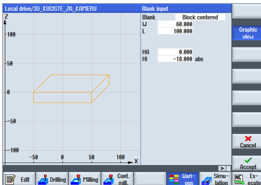
Slika 10.4. Tablica dimenzija priprema za 3D glodanje
