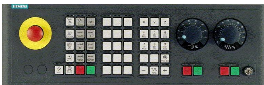
Slika 2.2. Upravljački panel CNC glodalice - MCP 483 C PN
