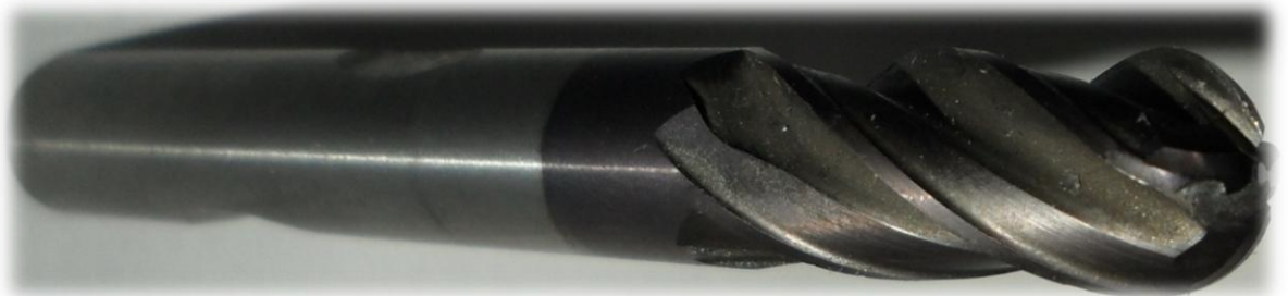
Slika 8.3. Glodalo promjera 10mm i radijusa oštrica R5
