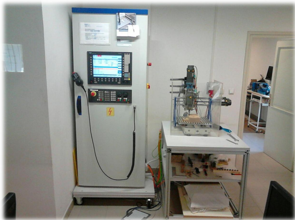
Slika 1.1. Izrađena CNC glodalica na kojoj će se testirati CAD/CAM/CNC lanac
