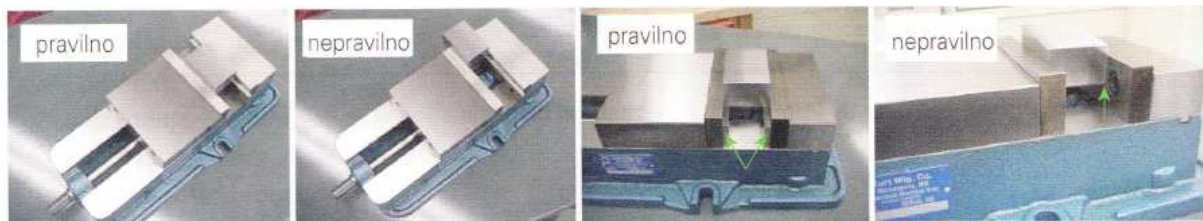
Slika 15. Pravilno i nepravilno stezanje obradka u škripac [5]
