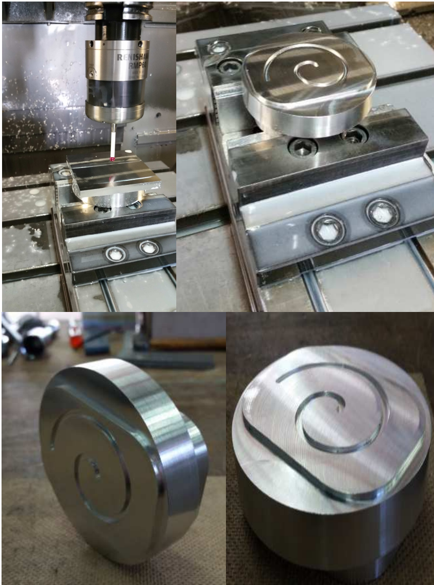
Slika 34. Izgled stezanja i gotovog obradka
