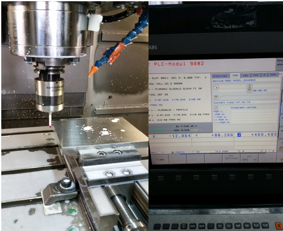
Slika 61. Mjerni sustav Touch Probe i programski kod učitani na stroj
