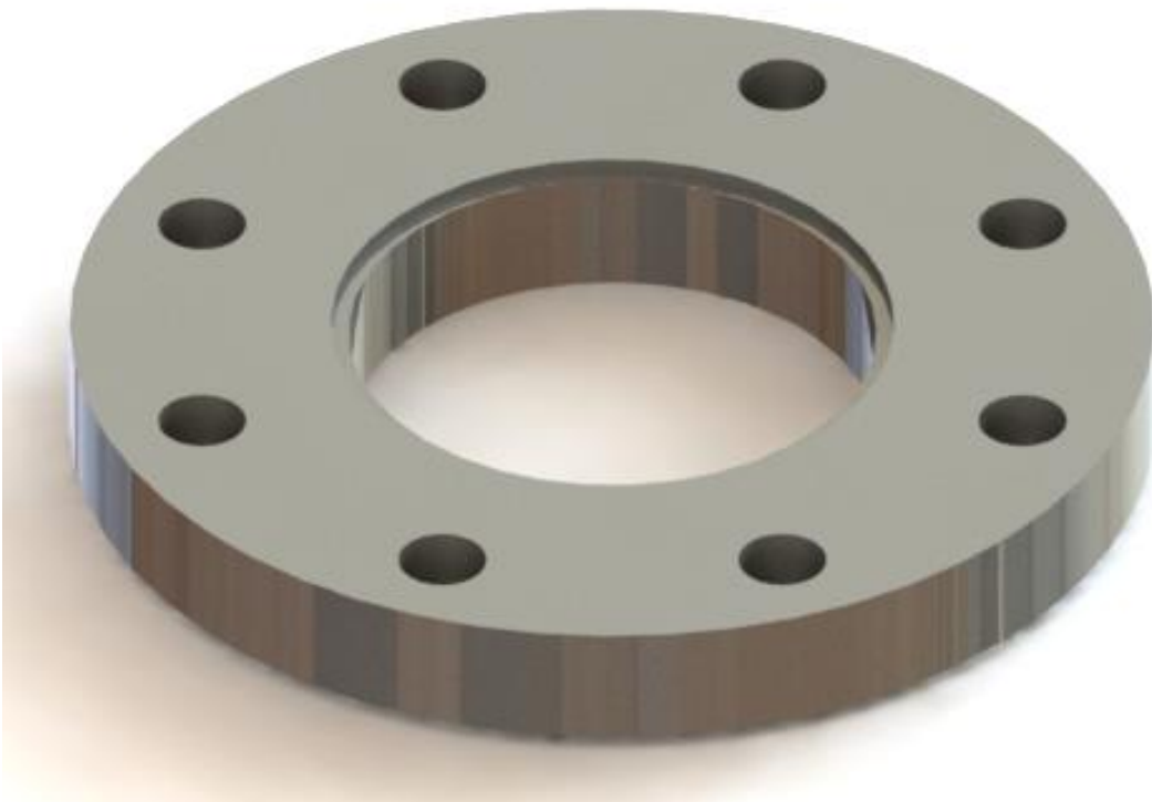
Slika 4.52 Renderirani (foto-realističan) 3D transparent model prirubnice pročištača PY-100.10
