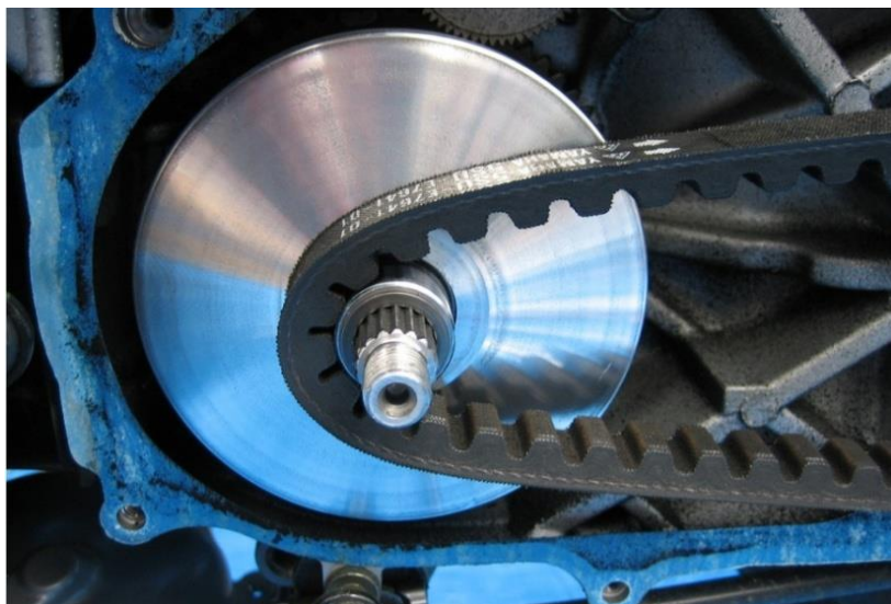
Slika 2.6 Primjer korištenja klinastog remena [7].
