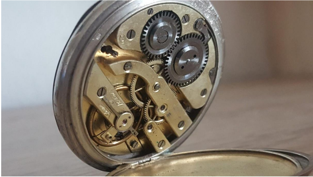
Slika 2.13 Primjer zupčanog prijenosa [11].
