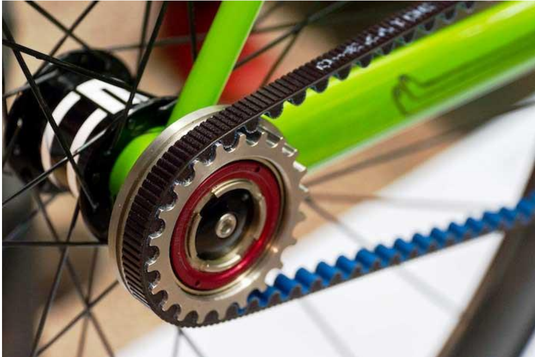
Slika 2.8 Primjer korištenja zupčastog remena [8].
