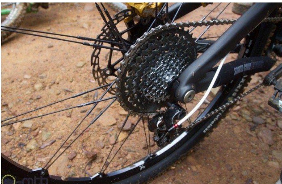
Slika 2.10 Primjer lančanog prijenosa [9].
