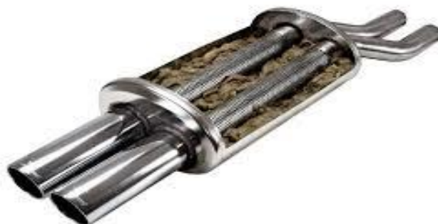
Slika 2.5. Unutrašnji dio apsorpcijskog prigušivača [9]
