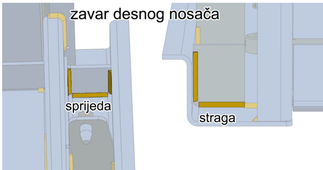
Slika 4.44 Mjesto zavara desnog nosača
