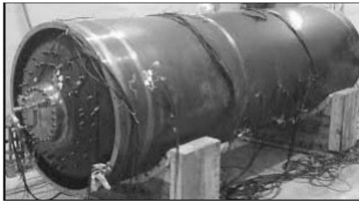
Slika 2.16 Kućište raketnog motora izrađenog od MARAGING čelika [6]
