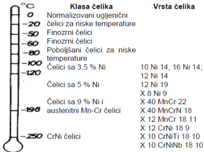
Slika 2.19 Temperaturno područje primjene klasa i vrsta čelika [7]
