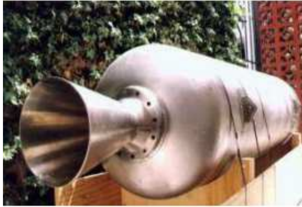
Slika 2.11 Kućište raketnog motora izrađeno od visokolegiranog Cr-Ni čelika [6]
