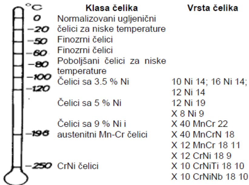
Slika 2.19 Temperaturno područje primjene klasa i vrsta čelika [7]
